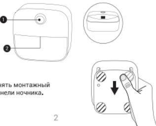
Сдвиньте вниз, чтобы снять монтажный кронштейн на задней панели ночника.
