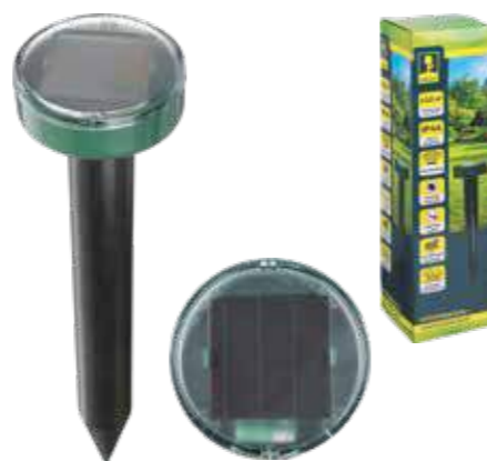
ОТПУГИВАТЕЛЬ КРОТОВ УЛЬТРАЗВУКОВОЙ, 250×60×60 ММ, НА СОЛНЕЧНОЙ БАТАРЕЕ 2 В/30 МА, IP44, 650 М²
