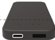
Гнездо Type-C используется для подзарядки аккумулятора
