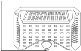
В светлое время суток светильник заряжает встроенный аккумулятор от солнечной панели. Для эффективной зарядки встроенного аккумулятора необходимо разместить светильник так, чтобы на солнечную панель попадало максимальное количество солнечного света. Если светильник не используется длительное время, необходимо перевести выключатель в положение OFF.
